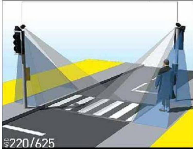
איור 5.14. דוגמא למערכת עם שני גלאים: גלאי הולך רגל לזיהוי דרישה לחצייה - באזור הכחול, וגלאי הולך רגל להארכת זמן פינוי - באזור האפור (אנגליה).
