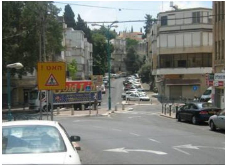
איור 4.18. צומת הרצלייה-הנביאים בחיפה: שלט אזהרה א-43 המכיל את המילה "האט" ותמרור אזהרה א-36 "מעבר חצייה לפניך", עקב המצאות מעבר חצייה אחרי עיקול. סימוני דרך הקשורים לצומת הם: חיצים ד-13, נתיבים ד-1, ד-4, ד-5, איי תנועה צבועים ד-14, אבני שפה צבועות ד-14, ד-15. במעברי חצייה בצמתים לא מרומזרים, הבלטת הצומת לעיני הנהג בדרך הראשית יכולה לסייע במשיכת תשומת ליבו גם למעבר החצייה שבצומת. יש לבחון את פתרון הבלטת הצומת באמצעות הוספת סימוני דרך הקשורים לצומת (איור 4.19).
