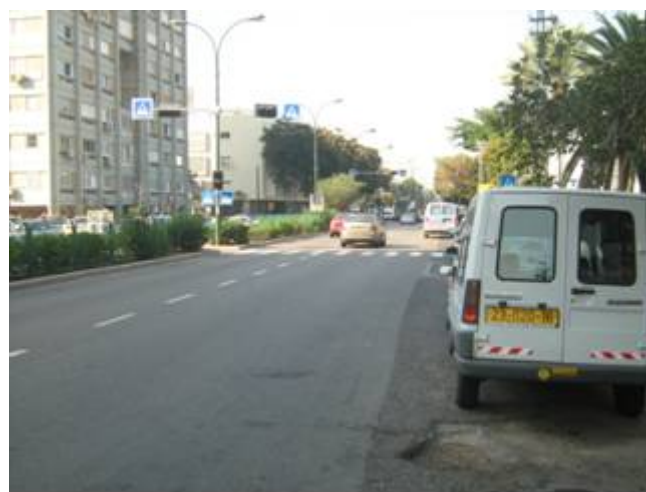
איור 4.11. רחוב פנקס 48 בתל אביב: שני נתיבים המשכיים ברוחב 7.8 מ', רצוי להצר לרוחב של 6.5-7.0 מ'.
