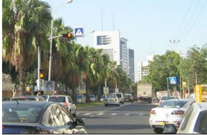
איור 4.17. צומת שאול המלך-הנרייטה סולד בתל אביב: הבלטת מעבר החצייה באמצעות סימון ד-11, תמרור ג-7 צידי ועילי מאיר מואר ופנסים מהבהבים ה-8 עיליים צידיים.
