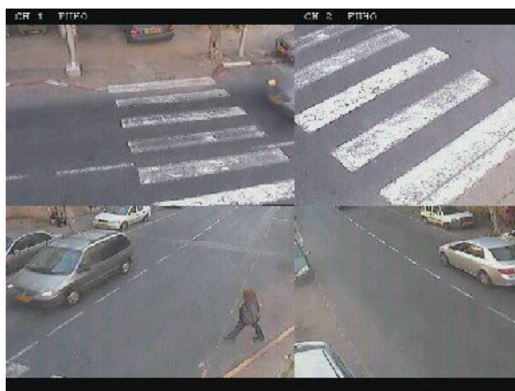
תמונה 12: עבירה מסוג 5 - ה"ר ירד לכביש ובאותה עת כ"ר נמצא בגישה למעבר החציה באופן כזה שאינו יכול להספיק לעצור לפני המעבר. הולכת הרגל (נראית בצילום משמאל למטה) ירדה לכביש מחוץ למעבר החציה. כלי הרכב (המיניוואן, נראה באותו צילום) אינו יכול לעצור כלל, שכן הוא מצוי במהירות של כ-42 קמ"ש במרחק של כשני מטר מן המעבר. למרות שהמקרה מוגדר כעבירה, ברור כי הסכנה כאן מועטה יחסית.
